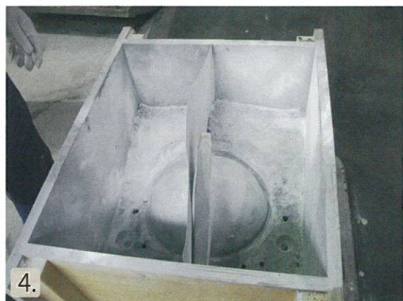
4. 砂型は、左右に分離できるよう、ヘルメットの羽根に沿って、仕切り板をいれました。
