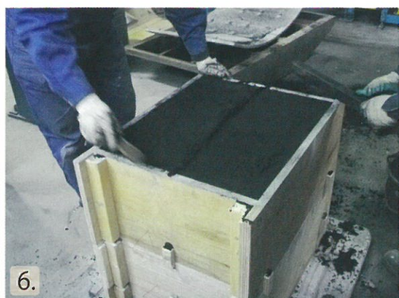
6. 上部まで埋め込まれた砂を硬化させて、砂型をばらして、石膏型を取り出します。鑄型は仕切り板で仕切られて、全部で7パーツに分割されました。
