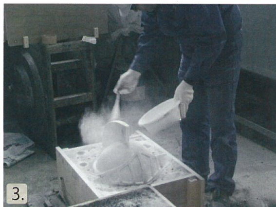
3. 石膏型には、込める砂との付着を防ぐために、パーチン粉を塗布します。
