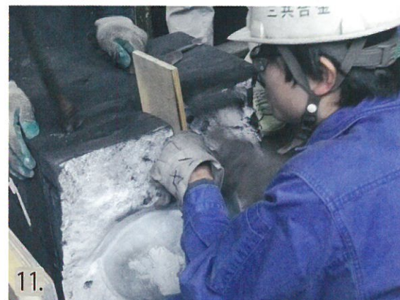
11. 鑄型を左右に分割するために、慎重に外していきます。
